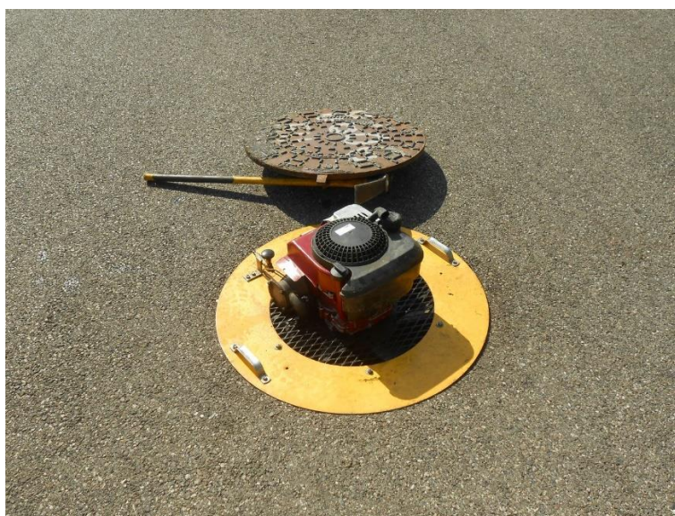
Figure 46 : Dispositif de générateur de fumée posé sur un regard d'eaux usées
