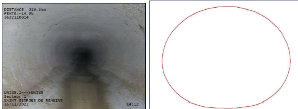
Figure 42 : Déformation verticale tronçon 39-39.1
