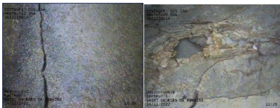
Figure 35 : Fissure tronçon 2-3 et Rupture tronçon 6-7
